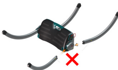
Feil montering (ikke monter bena først)
